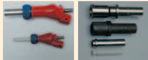
Strahlpistolen mit verschiedenen Leistungen Stahl-, Keramik- oder Borkarbiddüsen
