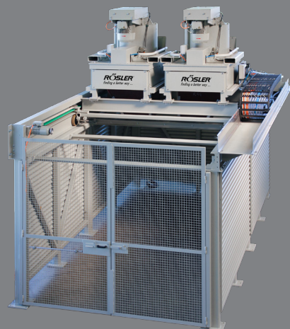
2x RZ 150 A auf verfahrbarem Untergestell, Schlammensorgung in Container
